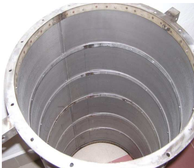
Obr. 4. Vnitřní distančními kroužky v trubním systému
